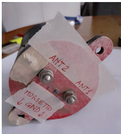
Fig. 4 - Il BALUN UT-2000 "lato antenna", riparato e rinforzato per il distacco accidentale di una delle due "orecchie" di fissaggio
