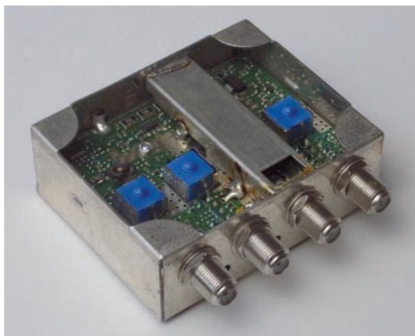
Fig. 3 - Modulo amplificatore V/UHF di nuova generazione, realizzato quasi interamente con SMD
