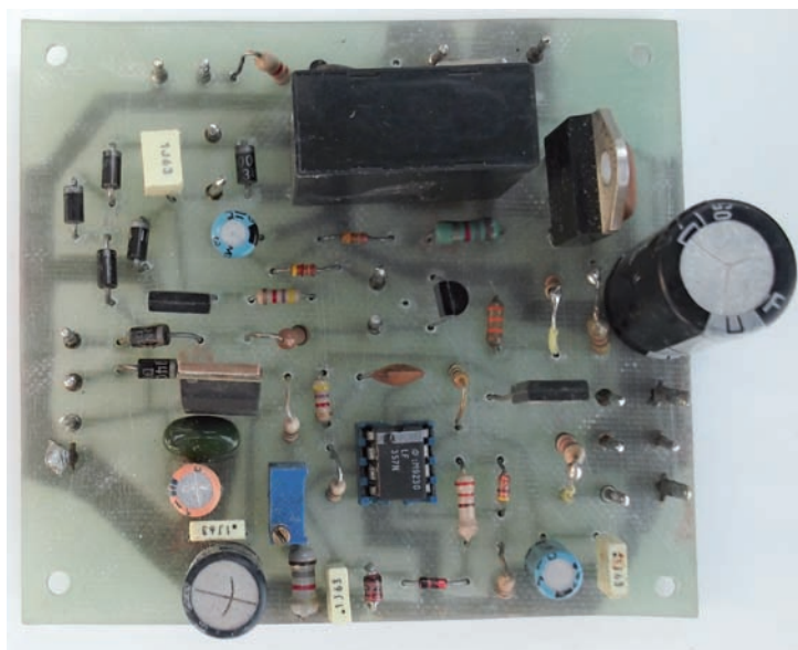
Fig. 9 - La basetta con il relè da 15 A
