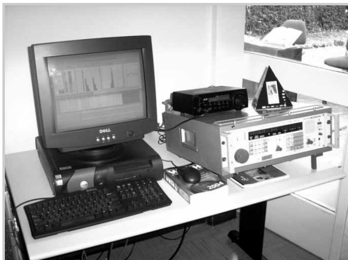
Postazione per il monitoraggio automatico delle onde corte. Un Rohde e Schwarz Ek070 (usato qui per il test di ricezione Dm) e un Aor 7030+
