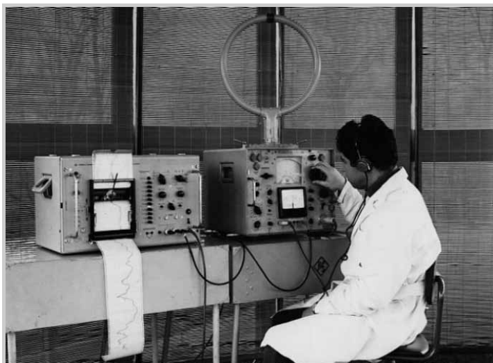
Un tecnico misura l'andamento dei segnali ricevuti sulle onde medie (anni Sessanta).
