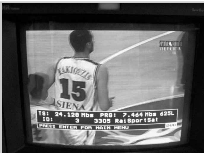
In sovrapposizione sullo schermo l'apparato di misurazione del segnale Dvb-T visualizza i parametri del flusso digitale. In particolare la banda complessiva (in megabit al secondo) e quella allocata al canale visualizzato al momento. Per una trasmissione sportiva ad alta variabilità dei contenuti, il tasso di compressione è più basso e il rate risulta più elevato.
