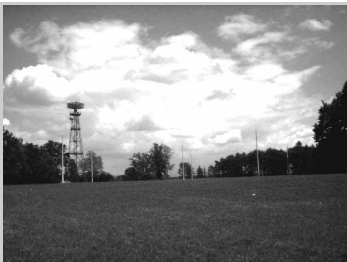
Una panoramica di una delle tre aree erbose che il Centro Raiway di Monza utilizza come parco antenne. Sulla sinistra è visibile la torre rotante delle antenne Vhf/Uhf. I pali bianchi sostengono il sistema di antenne rombiche per le onde corte. Altre antenne rombiche sono disposte in altre due aree intorno all'edificio principale del Centro.
