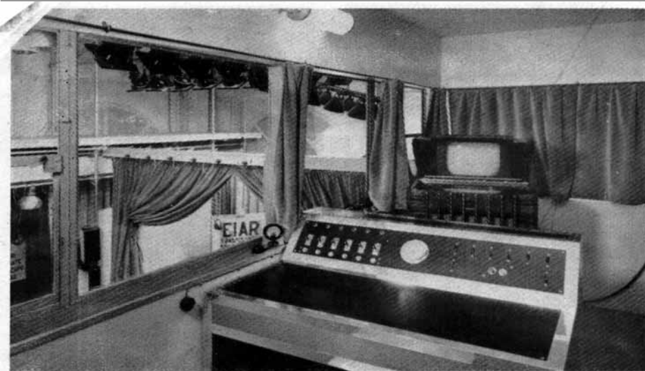
La cabina di controllo negli "studi" radiovisivi dell'EIAR; in fondo un apparecchio radio-ricevente fonovisivo permette di controllare le immagini; dalla lastra è visibile il sottostante studio di ripresa
