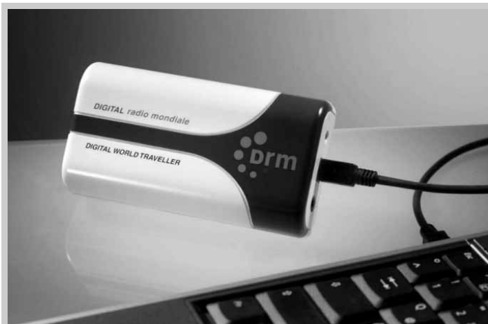
Ricevitore DRM da collegare al proprio ricevitore attraverso la porta USB: si tratta del Digital World Traveller realizzato dalla ditta tedesca Coding Technologies.
