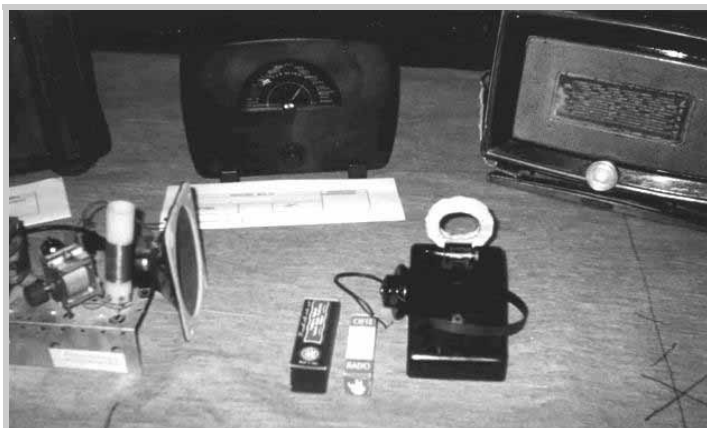
Radio a galena con antenna a nido d'ape; accanto un semplice ricevitore radio a reazione.
