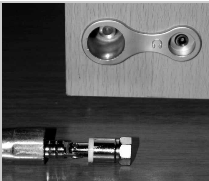
Particolare dell'antenna telescopica smontata, con chiave a tubo per il suo serraggio alla presa di antenna, troppo incassata nella radio per poter accedervi.
