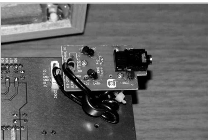
La presa per cuffie (non c'è altra uscita audio); curiosa la rete di adattamento.
