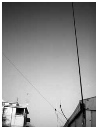
Particolare delle antenne all'esterno del capannone: fFilare di 25 metri terminata con balun, ground plane per 1090 MHz, verticale di 10 metri (foto: Carlo Pegan)
