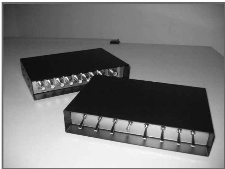
Vista fronte e retro dello Switchbox di FC.
