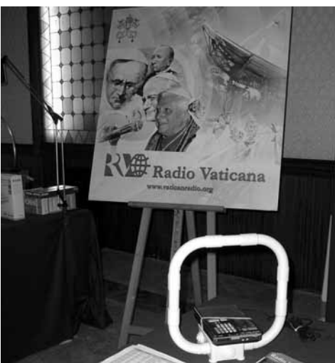
Nello stand della Radio Vaticana vediamo la piccola loop per onde medie costruita interamente con materiale elettrico da Renato Mercuri.
