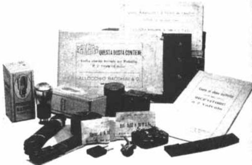
Scatola di montaggio Allocchio Bacchini, tipo "Radialba", per la costruzione domestica di un radioricevitore a due valvole (1928)
