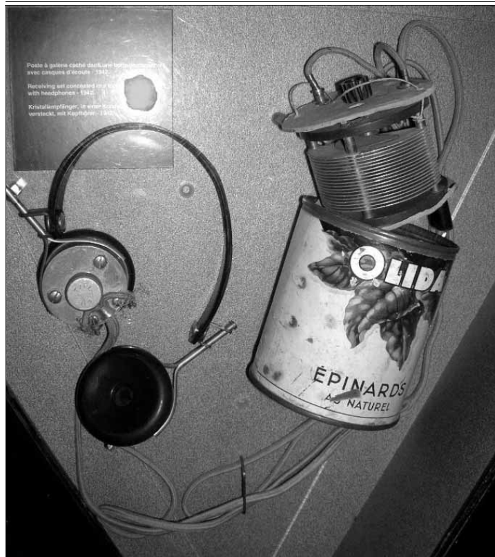
La radio a galena - A partire dal 1942, il partigiano di Caen André Heintz nasconde in una scatola di spinaci la propria radio a galena. Questa radio permetteva di ricevere le trasmissioni della BBC.
