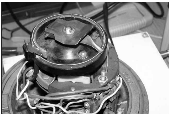
Motore aperto: in primo piano il potenziometro da 500 ohm.
