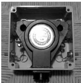
Sistemazione balun dentro la scatola stagna
