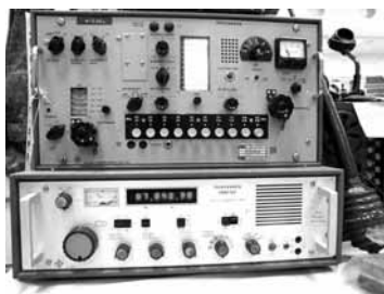
sopra: Ricevitore Telefunken ELK 639 copre la banda di frequenze da 9,8 kHz a 30 MHz (420,00 Euro)
