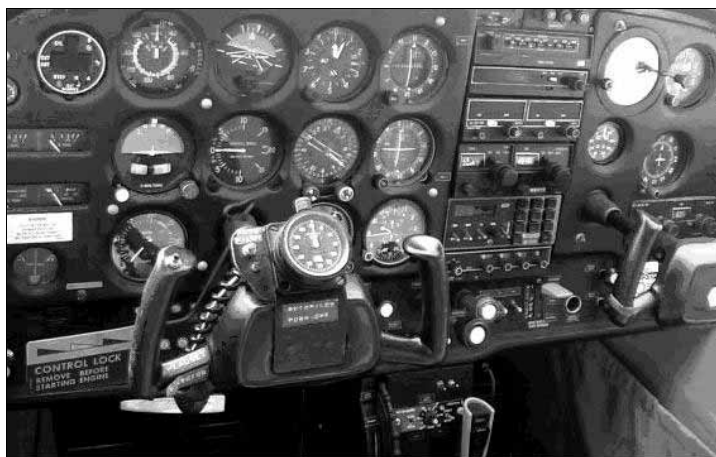
NDB Receiver - ADF UNITRA RADMOR ARL 1601 montato sul cruscotto di un aereo Cessna 172 SP-FEP.
