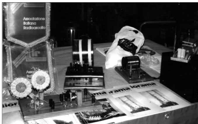
Ricevitori a galena o a diodo, costruiti da Roberto Martini.
