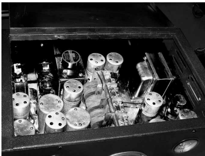
Ricevitore BRETING Radio MFG, supereterodina, 12 valvole, fonia AM - Telegrafia , Freq. 0,5-30 MHz, Anno 1935.
