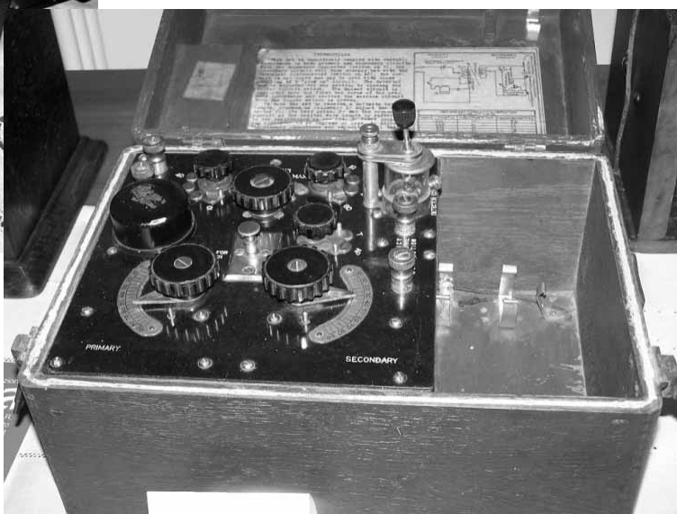
Ricevitore Deforest Mod BC14A a cristallo di galena, anno 1914, usato dai reparti di artiglieria nella prima guerra mondiale e in seguito dai radioamatori.
