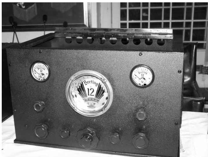
Ricevitore BRETING Radio MFG, supereterodina, 12 valvole, fonia AM - Telegrafia , Freq. 0,5-30 MHz, Anno 1935.
