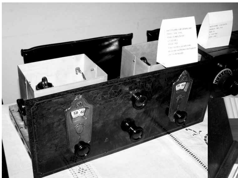
Ricevitore a reazione PILOT CO USA, Mod. Super WASP 4 valvole, Anno 1929, primo ricevitore per OC che usa un amplificatore alta frequenza con valvola bigriglia.
