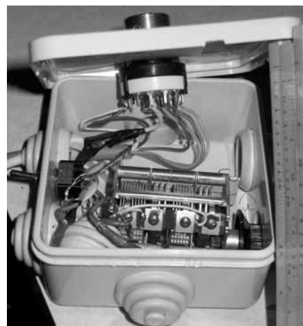
Foto 6 - Interno box di controllo con commutatore, condensatori e switch.
