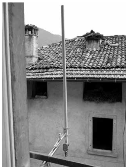
Foto 4 - Antenna finita "astucciata" in tubo da 32 mm.
