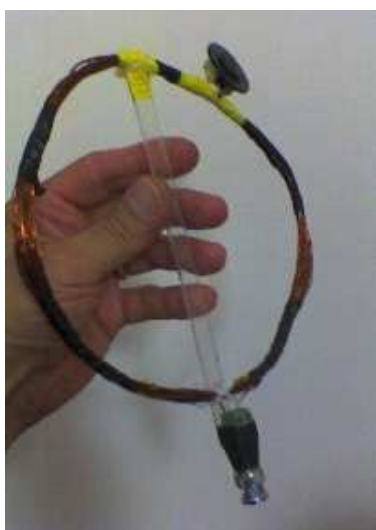
Miniloop per onde lunghe 40 spire , particolare del c.v. ex radiolina e dell'attacco BNC-mammuto
