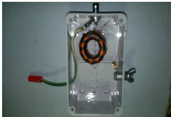
Contenitore con Toroide per Balun (1:32)
