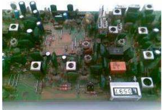
Immagine della IF UNIT con i filtri AM (arancione) e FM narrow (corpo metallico) sostituiti.
