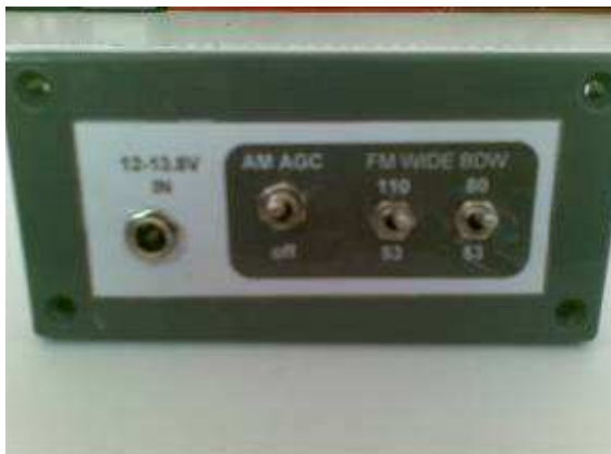
Presa Teko installata posteriormente al ricevitore. A sinistra la presa di alimentazione esterna.
