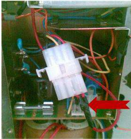
Alimentatore interno: dettaglio della presa volante con ponticello su cui saldare il cavetto proveniente dalla presa a pannello.
