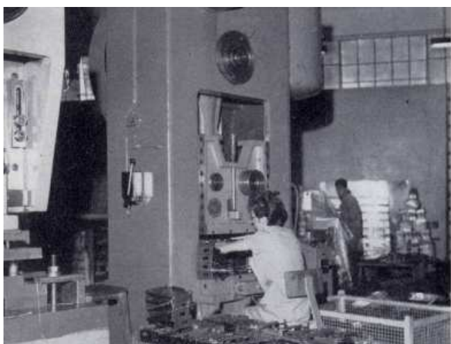
Trancia per la produzione degli "chassis"
