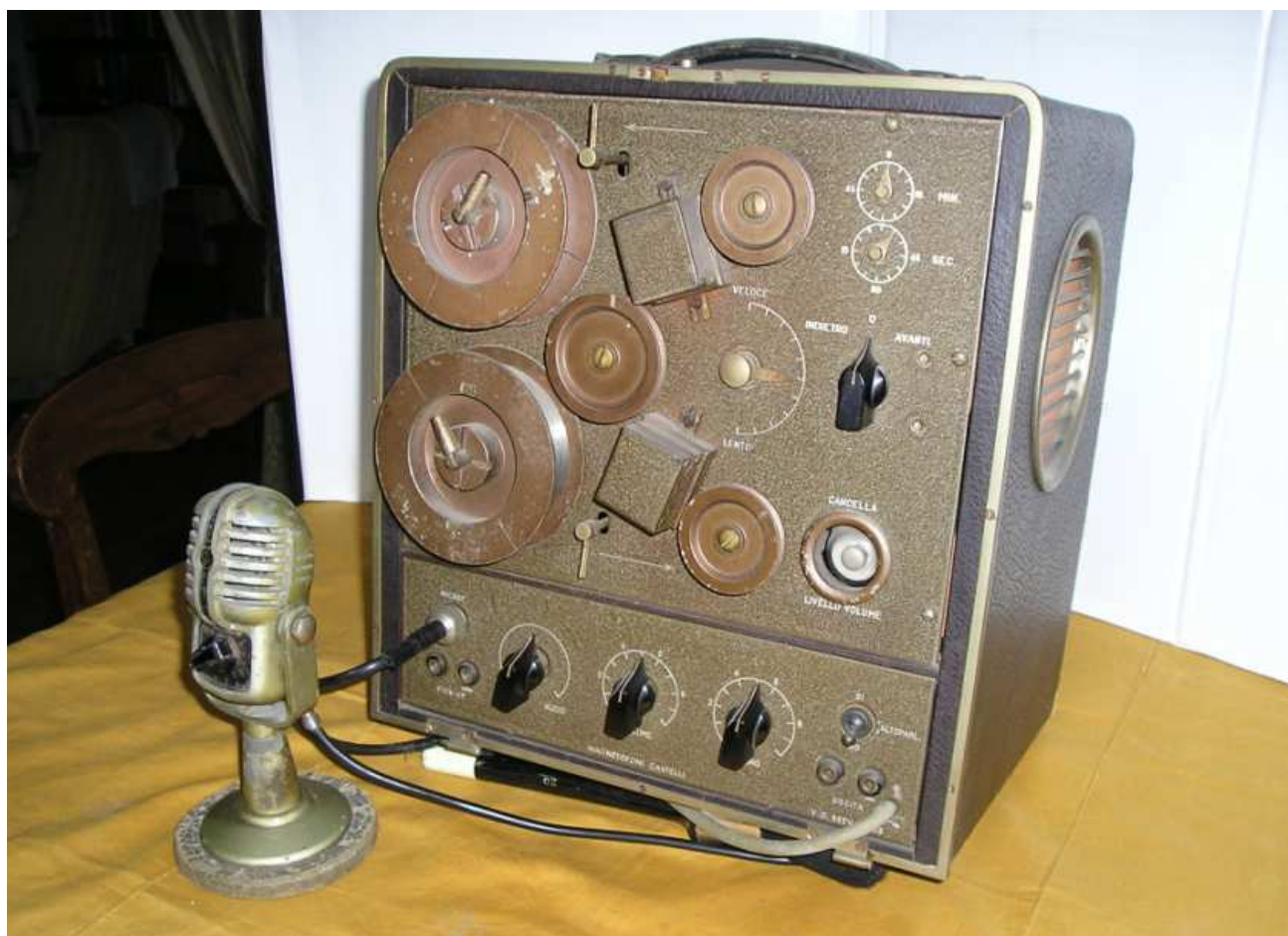
Primo registratore a filo costruito dalla Magnetofoni Castelli 1947
