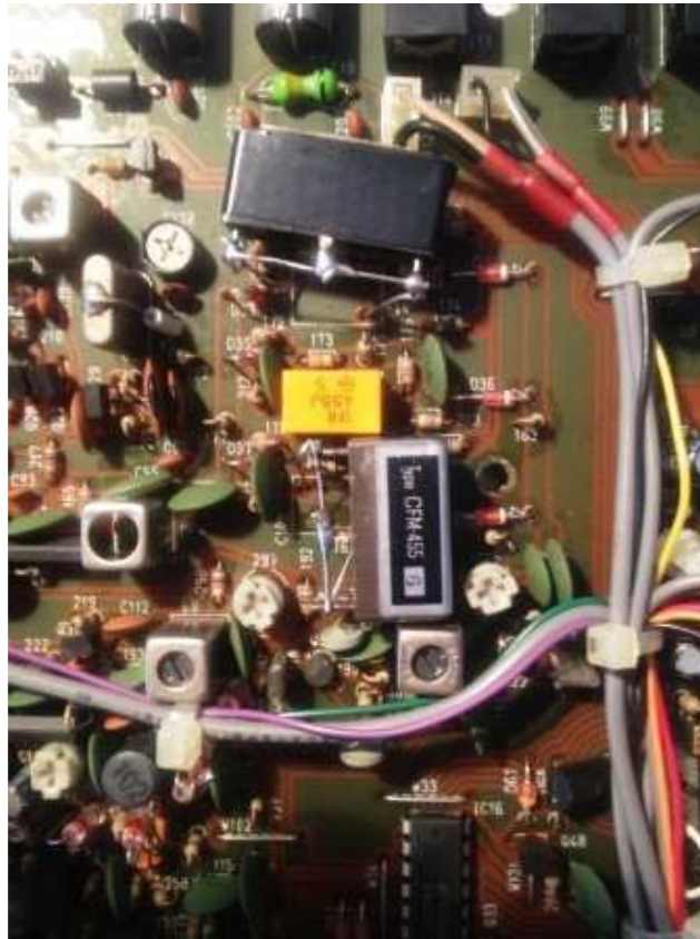
Fig.7: i filtri nuovi posizionati sulla main unit
