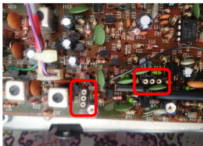
Fig.9A: i filtri originali rimossi e gli "zoccolini"
