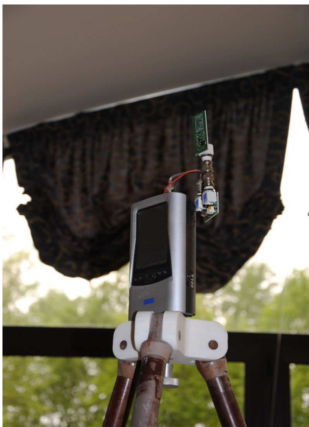
Misura della Miniwhip senza cavo, su cavalletto dielettrico
